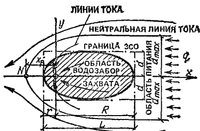
Рис. 62. Схема фильтрации подземных вод к водозабору
