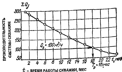
Рис. 107. Расчетные графики изменения во времени \xi_h(t) , Q_j(t) и \Sigma Q(t) при действии скважин в режиме S_j = \text{const}
