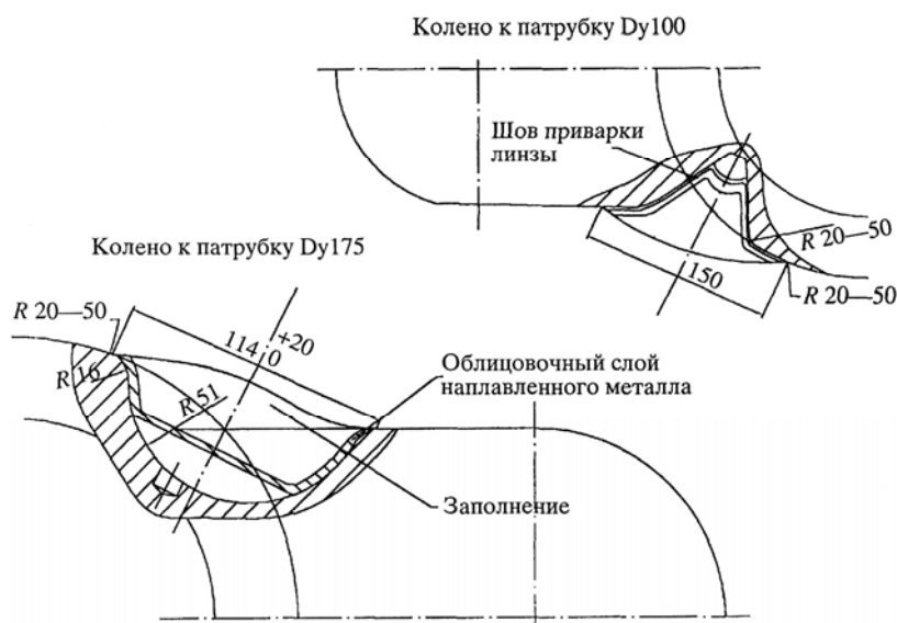
Рис. 14.5. Ремонт паровой коробки IV клапана турбины Т-110/120-130
