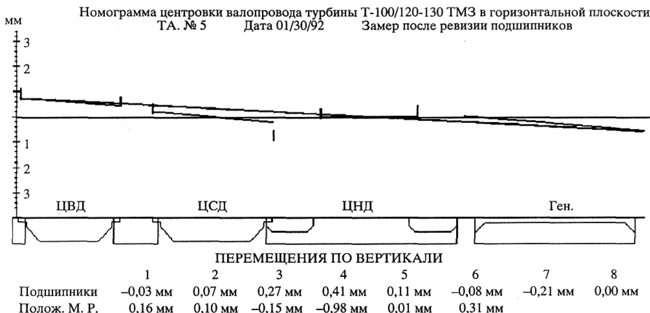
Рис. 10.9. Номограмма центровки роторов турбины Т-100/120-130 в горизонтальной плоскости
