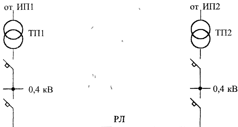
Рис. 6.6. Схема электроснабжения с применением однотрансформаторных ТП
